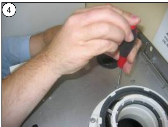
Odkręcić od góry śruby mocujące uchwyt wymiennika ciepła, wyjąć uchwyt od przodu
